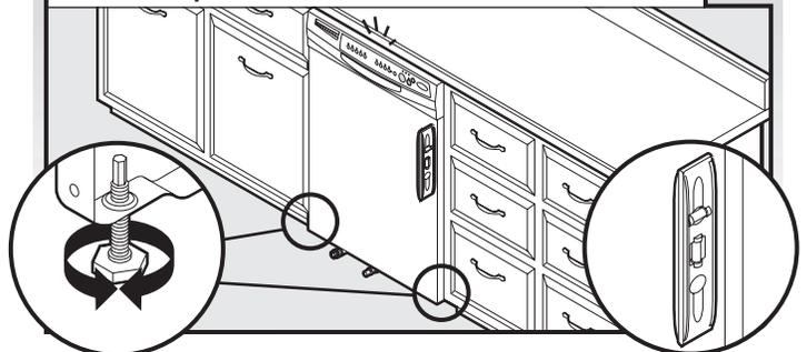
Vérifier que les pieds de réglage de l'aplomb sont fermement en contact avec le sol. Fermer et verrouiller la porte; placer un niveau en contact avec le panneau de façade. Vérifier que le lave-vaisselle est centré dans la cavité (avant/arrière). Si nécessaire, modifier le réglage des pieds pour établir l'aplomb du lave-vaisselle - effectuer ceci de chaque côté du lave-vaisselle.
